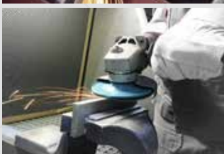
焊缝坡口加工
