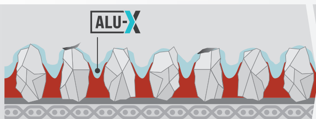
VSM ALU-X 附加涂层显著降低了附着力；磨料磨具使用寿命更长。
